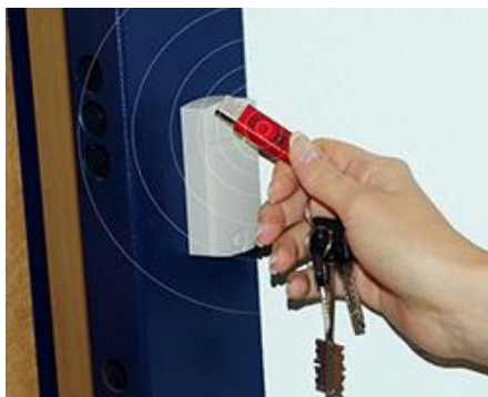
Рис. 2.16 – Пример системы на базе радиочастотного идентификатора и USB-ключа.
