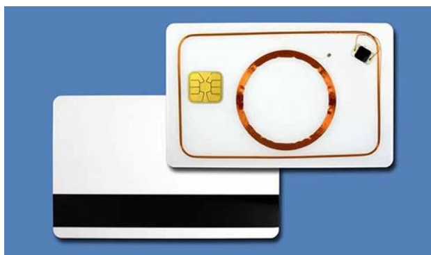
Рис. 2.17 – Пример гибридной смарт-карты.
